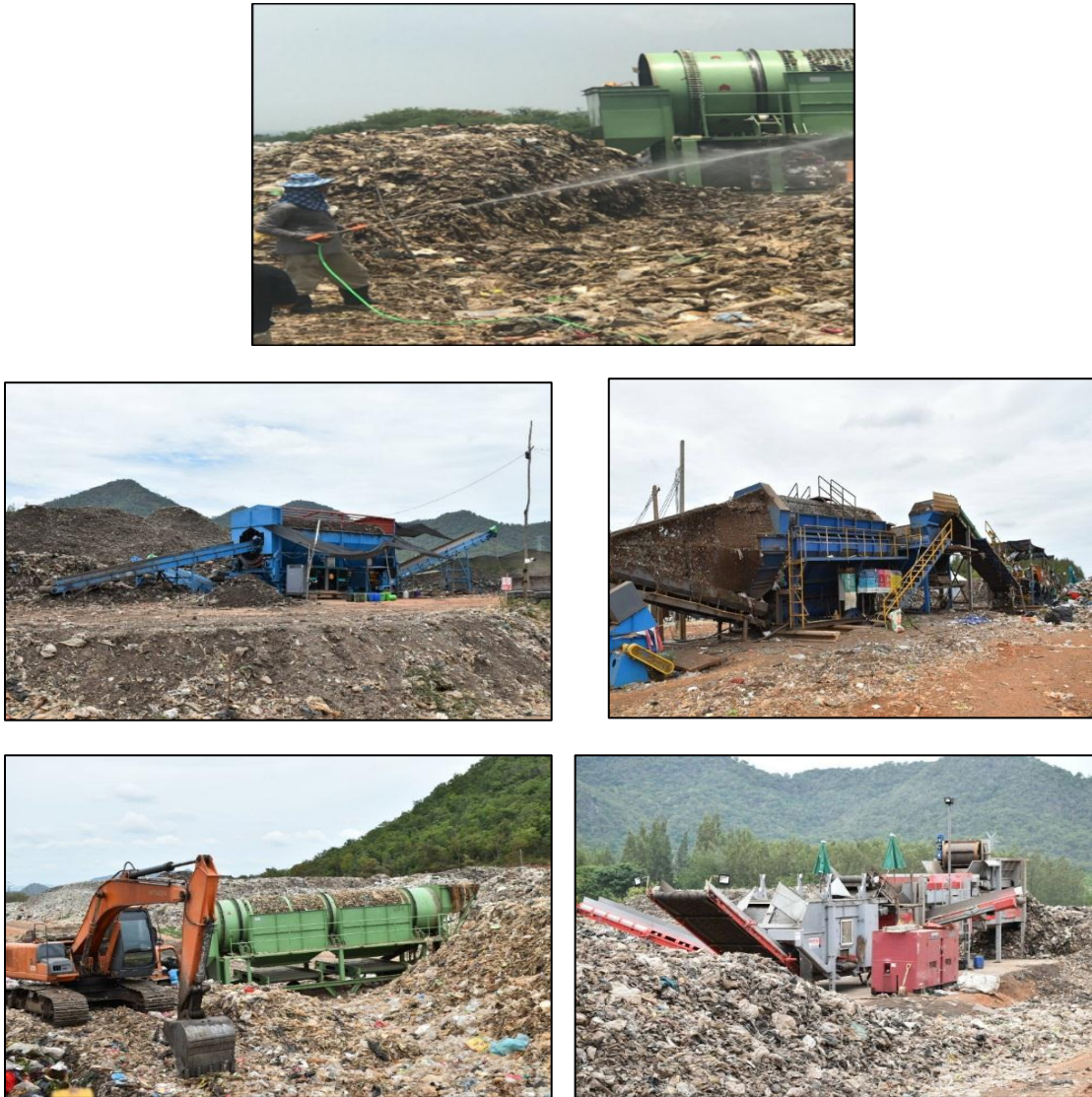
ภาพที่ 1 เครื่องคัดแยกขยะทำเชื้อเพลิงขยะ (Refuse Derived Fuel, RDF) ของเอกชนทั้ง 3 ราย
